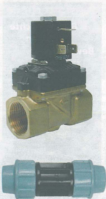
Oben: Messing-Hauptventil mit geringer Stromaufnahme für den Einbau in Innenräumen, für alle gängigen Steuergeräte mit 24VAC geeignet
